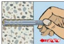
6. Helyezze be a horgonyrudat forgatva, míg a habarcs kijut.
