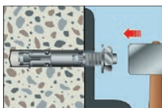
3. Helyezze be a csaphorgonyt a rögzítendő alkatrészén keresztül, és üsse be.
